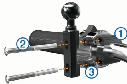
**REMARQUE :** des boulons standard de 1/4 po et des boulons M6 sont fournis avec le produit. Utilisez des boulons de même taille que les boulons d'origine du levier de frein ou d'embrayage.
